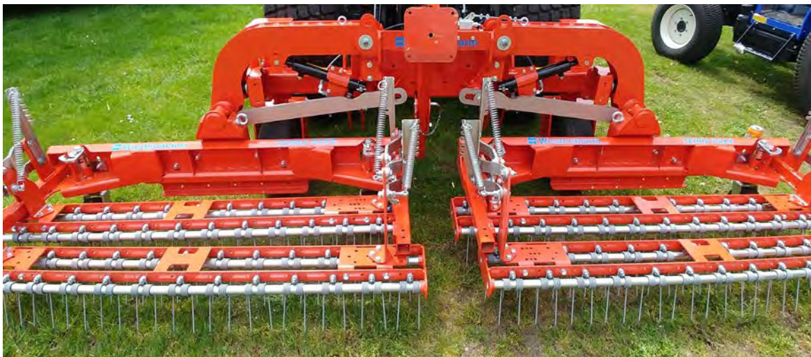
Figuur 5 Wiedeppen is een relatief effectieve, eenvoudige, snelle en betaalbare bewerking tegen onkruiden.
